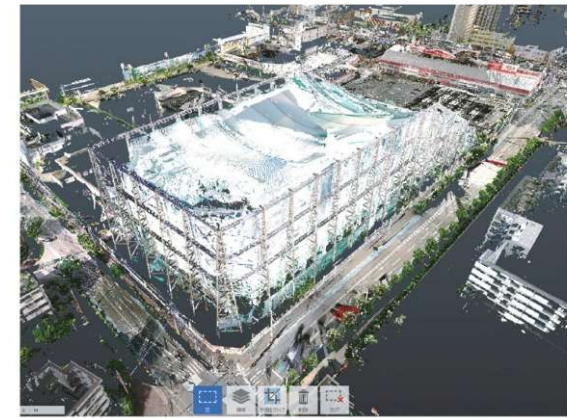
3DスキャナーでBIMモデル化
